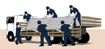
Para la descarga manual de los productos Kingspan MV, utilice el mismo número de hombres sobre el camión y en el suelo.
