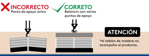
Para el manejo con grúa, los productos Kingspan MV deben ser apoyados sobre un tablón de madera o metálico, asegurándose de que la cinta de la grúa no toque el lateral del producto.
