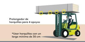
La descarga debe ser hecha, preferentemente, por un montacargas teniendo en cuenta el tamaño y la distancia entre las horquillas (3000 mm).
