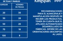
La manera correcta de hacer el apilado de los productos Kingspan MV es colocando los calces de EPS o de madera sobre los mismos y amarrarloss. Colocar los calces con una distancia máxima de 1 metro entre sí.
